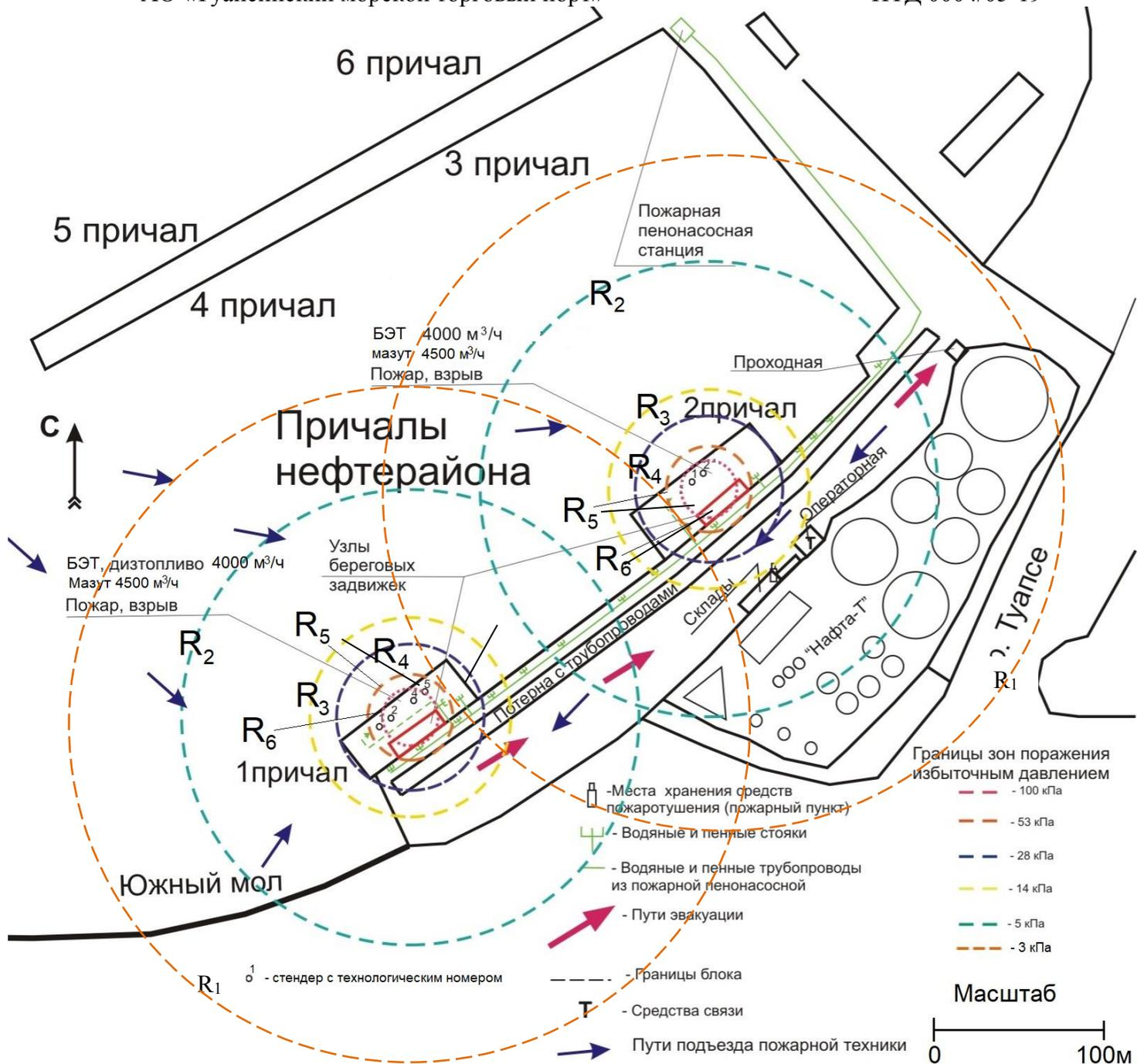
Сценарий - разгерметизация стендера, образование пролива БЭТ, образование взрывоопасного облака, взрыв при наличии источника зажигания.
